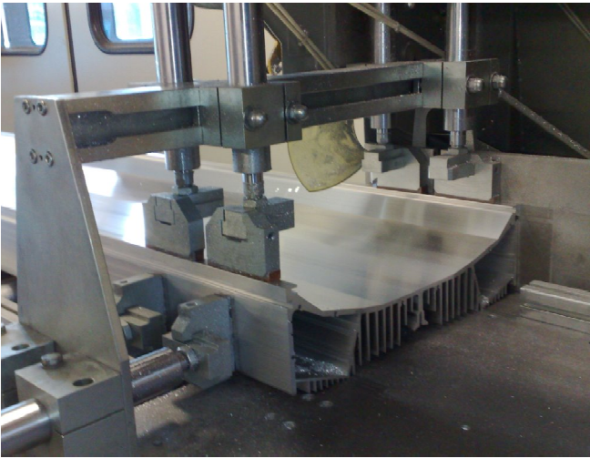
FOTO DE EJEMPLO: SE REALIZAN OPERACIONES DE CORTE A MEDIDA EN PERFILES DE ALUMINIO
