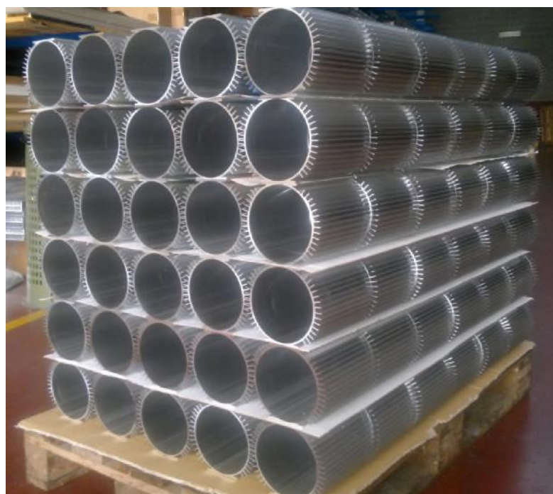
FOTO DE EJEMPLO: PERFILES DE ALUMINIO EXTRUIDO PARA CARCASAS DE MOTORES ELÉCTRICOS
